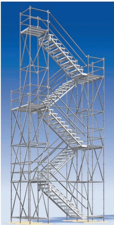
Beim Allround-Bautreppenturm 200, 12-stielig, werden die Treppen jeweils aus 2 separaten U-Treppenwangen 200 und Serienböden als Stufen zusammengesetzt.
