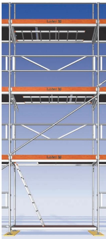
Die preiswerte Variante für den Aufstieg im Gerüst: Durchstiegböden – funktional den Gerüstböden gleich – sind Arbeitsboden, Aussteifungselement und Aufstieg im Gerüst, Materialtransport ist in begrenztem Umfang möglich.
