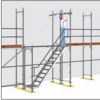
Bild 53: Verbindung zum Hauptgerüst
